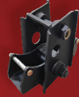
لعاب وسط عرض ١٠ ارتفاع ٣٦ سم سماكة ١٠ ملم + ميزان وسط ١٢ ملم Lowbed Middle Hanger 36cm
